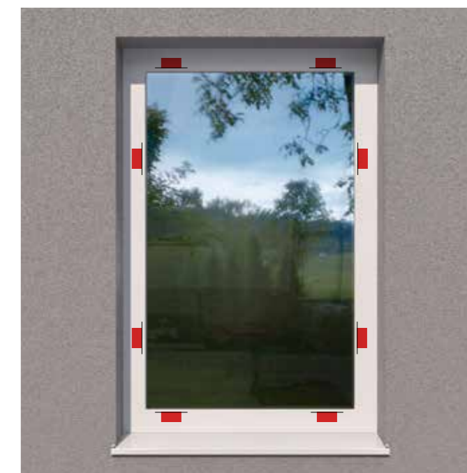
Az I-tec Secure reteszelési pontok szabványos elrendezése
